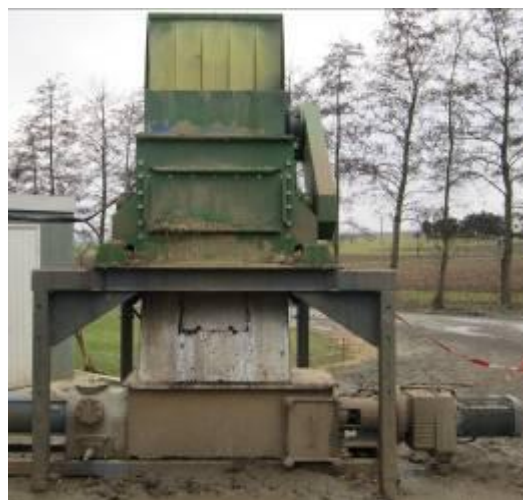
Abbildung 12: Zerreißer mit hohem Durchsatz und direkt angeschlossener Pumpe, allerdings steinempfindlich.
