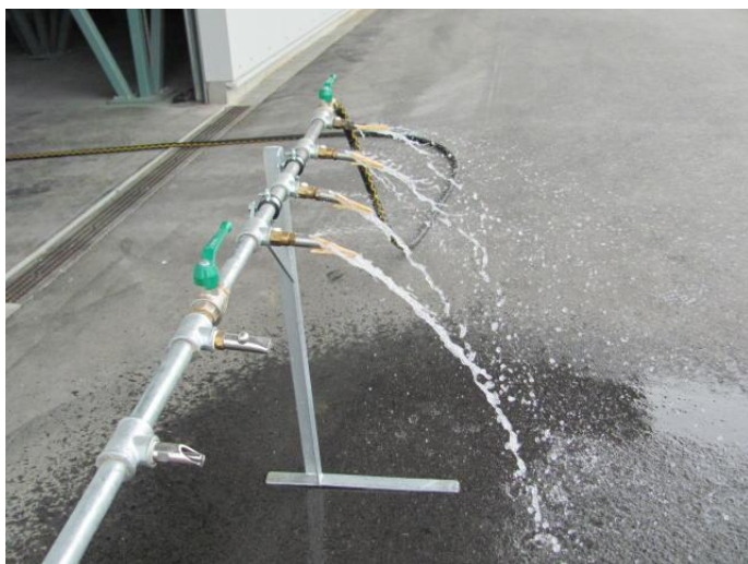
Abb. 5: Unterschiedliches „Spritzbild“ von baugleichen Tränkenippeln bei gleicher Einstellung
