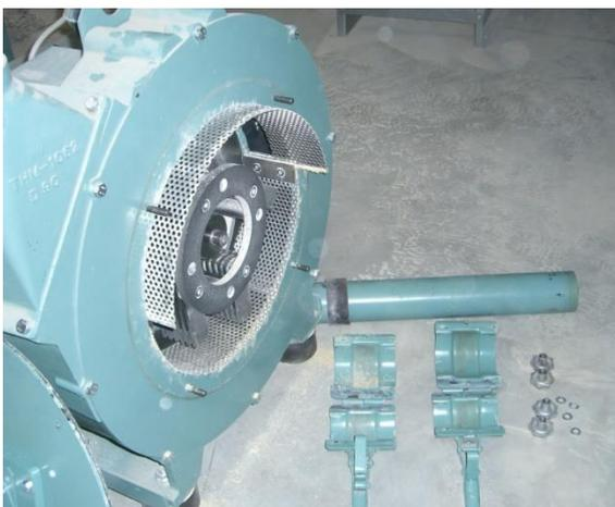
Abbildung 4: Siebwechsel an der Mühle
