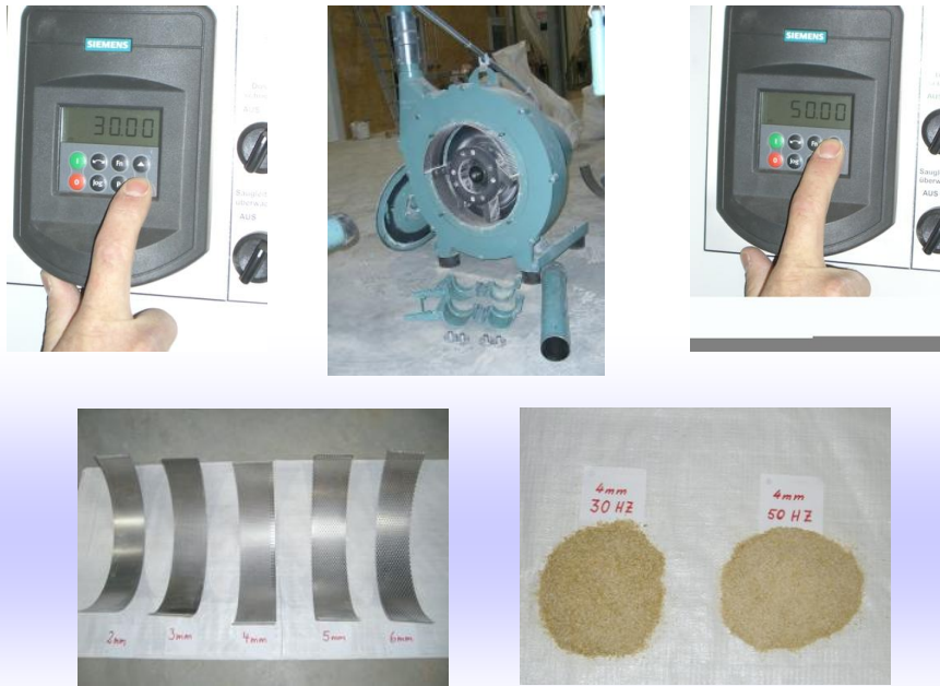
Abb. 1: Hammermühle in Schwarzenau (11 kW) mit Wechselsieben und Frequenzumrichter
