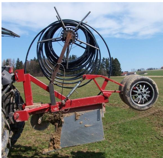
Bild 6: Schlauchpflug mit automatischen Schlaucheinzug
