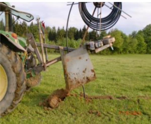
*Bild 4: Schlauchpflug mit automatischen Schlaucheinzug*
