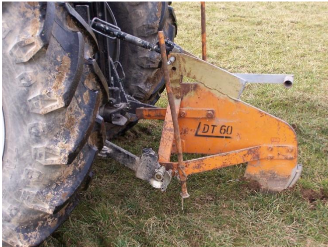
Bild 4 und 5: Umgebauter Drainagepflug; Wasserleitung wird nachgezogen
