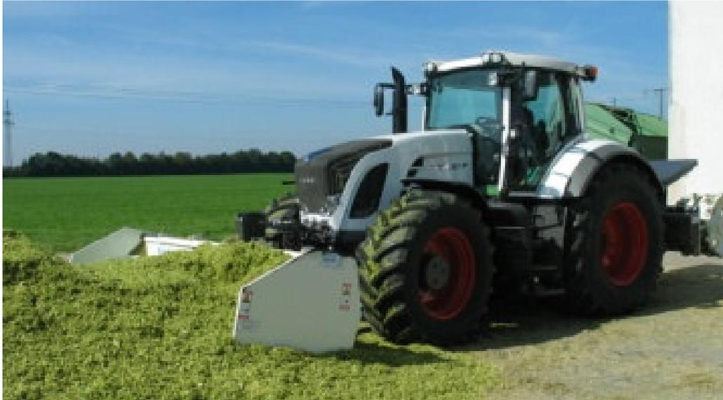
Bild 3: hydraulisch in der Breite verstellbares Verteilschild im Frontanbau
