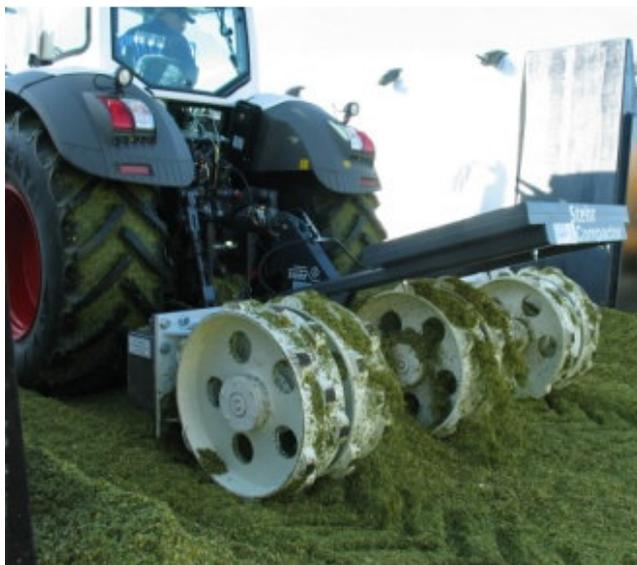
Bild 1: Das Verdichterrad mit Zusatzgewicht (über den Walzen)
