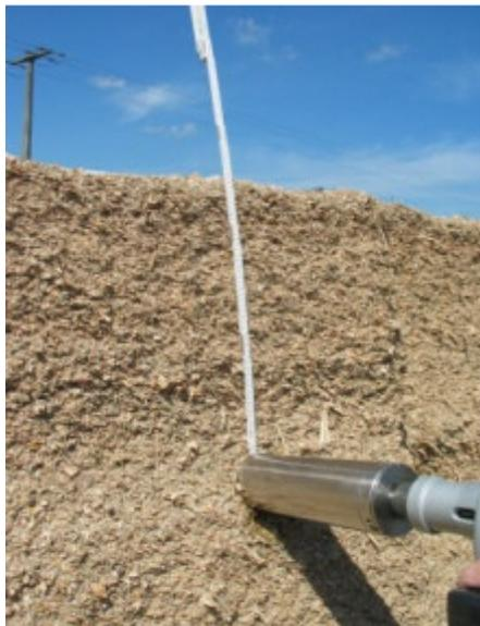
Bild 4: spezieller Bohraufsatz mit einem Durchmesser von 9,2 cm
