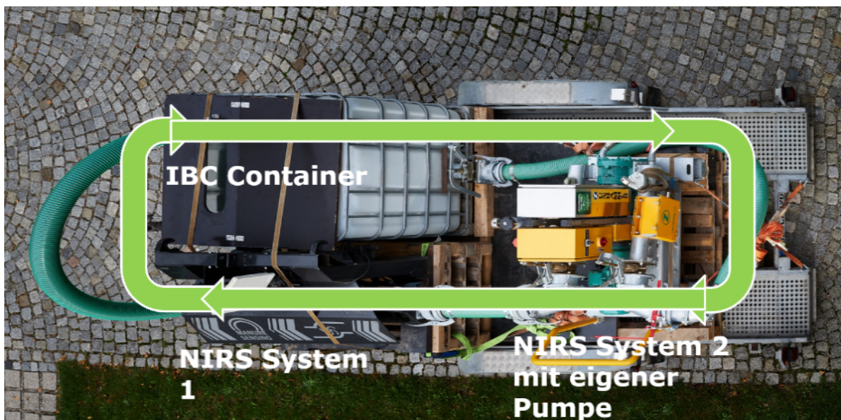
Abbildung 1: Im Projekt entwickelter Messanhänger mit IBC Container zur gleichzeitigen Ermittlung der Messgenauigkeit von bis zu drei NIRS-Sensoren, modular erweiterbar um einen dritten Sensor (nicht dargestellt)
