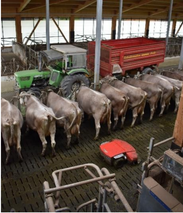
Abbildung 17: Der Entmistungsroboter soll seine Routen entsprechend den Ereignissen am Fressgitter anpassen. Sind die Kühe am Fressgitter fixiert, so soll der Entmistungsroboter diesen Bereich während seiner Entmistungsrouten auslassen.
