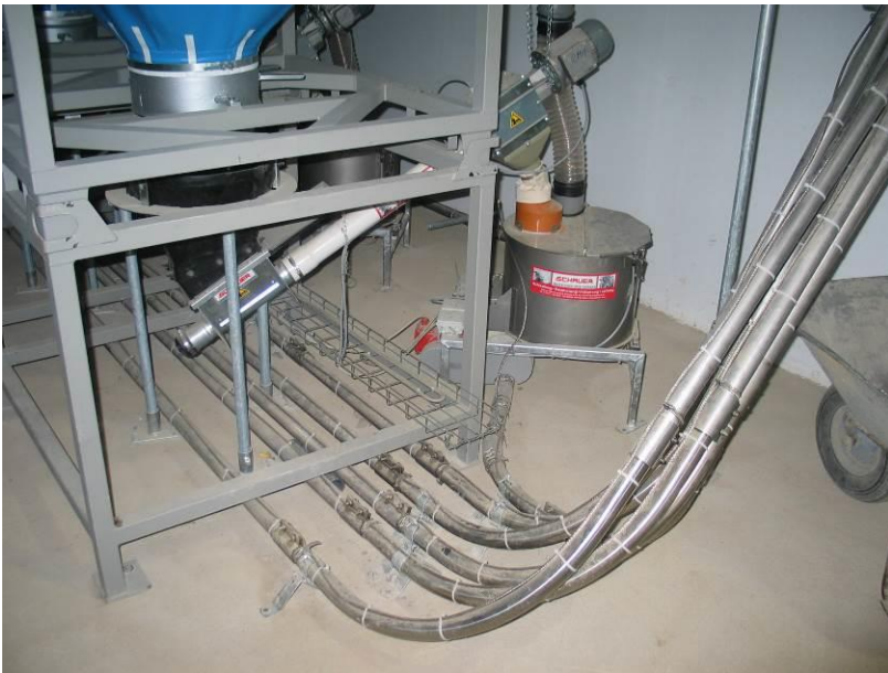
Abb. 5: Spotmix-Mini-Anlage zur Erfassung der Futterraufnahme für das Einzeltier bei säugenden Sauen
