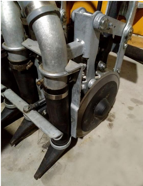
Abb. 9: Bei der Gülleinjektion werden mit einer Schneidscheibe Grasnarbe und Boden aufgeschnitten und nachfolgend die Gülle in den entstandenen Schlitz abgelegt. Das linke Bild zeigt das Prinzip der Technik, das rechte Bild das Ergebnis im Bestand.
