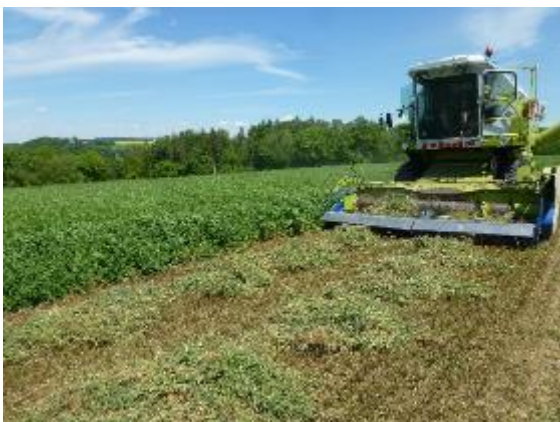
Abbildung 8: Prototyp des angepassten Mähreschers zur Ernte von Luzerneblättern (© Jan Maxa)
