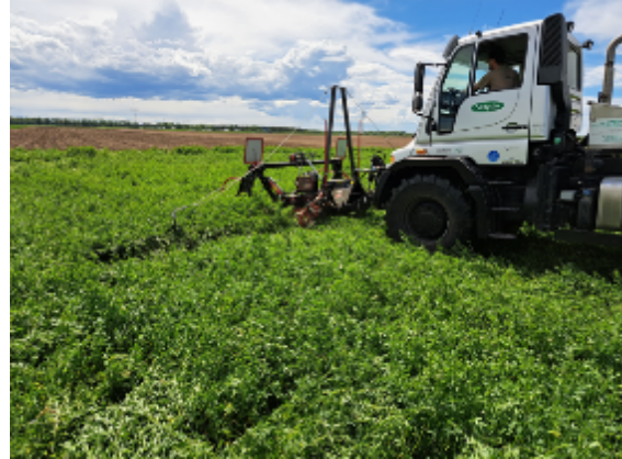
Abbildung 3: Doppelmessermähwerk mit mittlerer Aufhängung zum Erreichen der variablen Schnitthöhe (hier: Seco Duplex 900F der Firma BB Umwelttechnik) (© Stefan Thurner)
