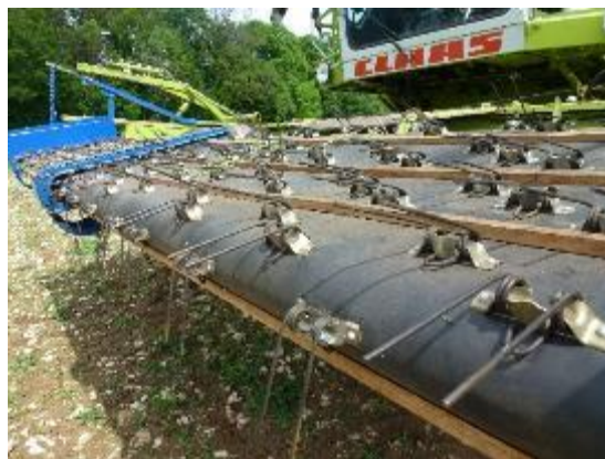
Abbildung 9: Pick-up des Mähreschers zur Ernte von Luzerneblättern (© Jan Maxa)
