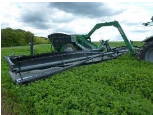
Abbildung 4: TopCut Collect mit Sammelbehälter von Zürn Harvesting (© Jan Maxa)
