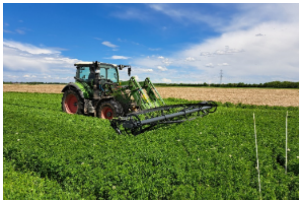
Abbildung 5: TopCut Collect im Frontladeranbau ohne Sammelbehälter von Zürn Harvesting (© Stefan Thurner)
