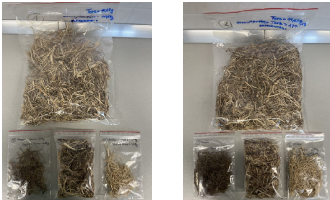
Abb. 21: Versuchsmuster aus der Entholzung der Hopfenstängel (jeweils oben) sowie daraus selektierte Fraktionen (jeweils unten links reiner Faserbast, Mitte Faserbast mit fest anhaftenden Schäben und rechts reine Schäben)
