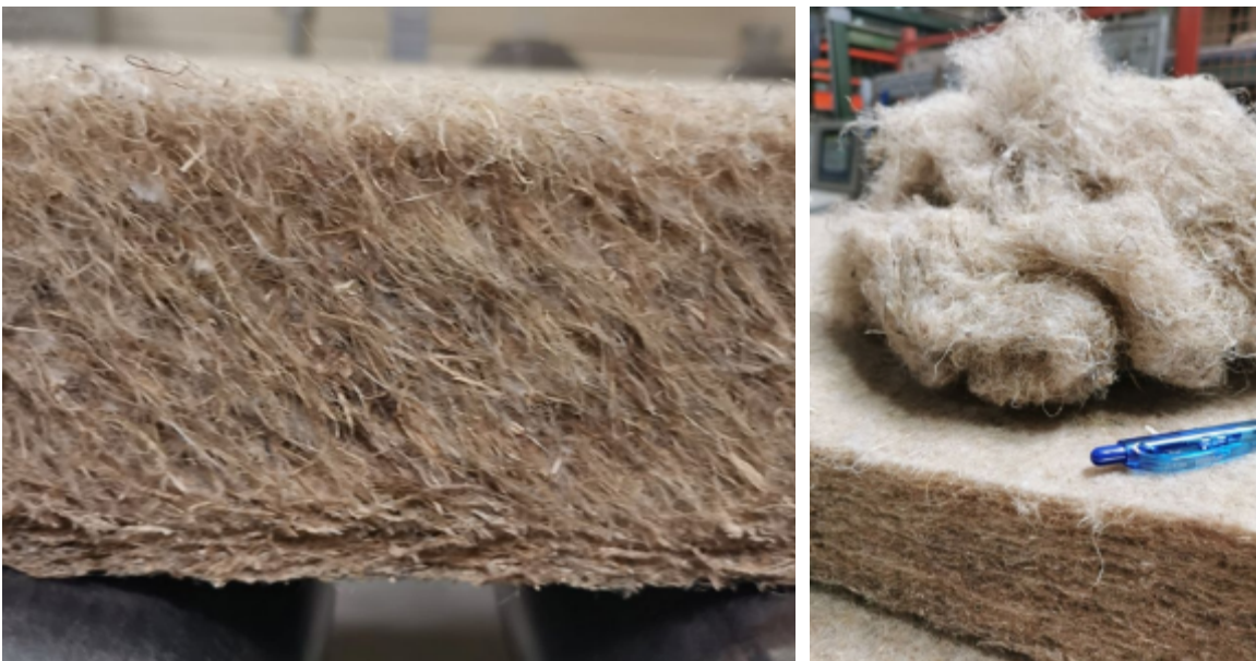
Abb. 27: fertige Dämmmatte aus 30 % Hopfen, 60 % Hanf- und 10 % Bindefasermaterial, im Vergleich zum Ausgangsfasermaterial (rechts)
