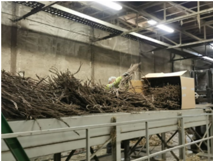
Abb. 19: Dosierung des Versuchsmaterials in den Entholzungsprozess der Firma HempFlax Group B.V. in Oude Pekela (NL)
