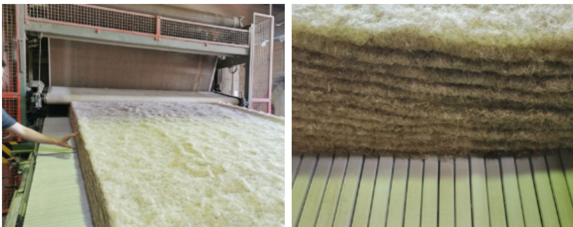
Abb. 25: Mehrschichtiger Flor vor thermischer Verfestigung
