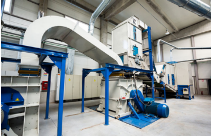
Abb. 18: Entholzungseinheit der Faseraufschlussanlage der Firma HempFlax Group B.V. in Oude Pekela (NL), Darstellung des Unternehmens
