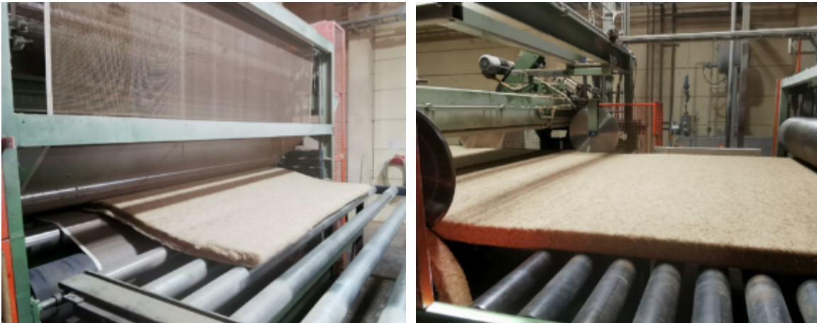
Abb. 26: thermische verdichtete Dämmmatte (links) und Breitenkalibrierung (Konfektionierung) des Produktes (rechts)
