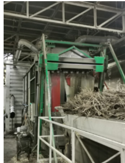
Abb. 19: Dosierung des Versuchsmaterials in den Entholzungsprozess der Firma HempFlax Group B.V. in Oude Pekela (NL)
