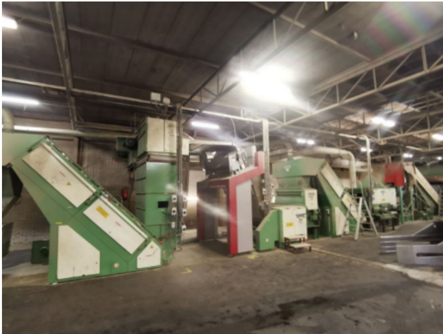
Abb. 20: Faserreinigungs- und Faseröffnungslinie der Firma HempFlax Group B.V.; (links, Mitte und rechts Stufenreiniger, dazwischen Faseröffner)
