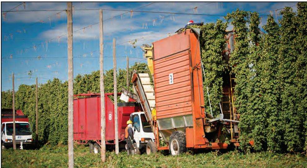
*Abb. 29: „Field Harvester“ im Einsatz auf einer US-Hopfenfarm. Quelle: Hopsteiner*
