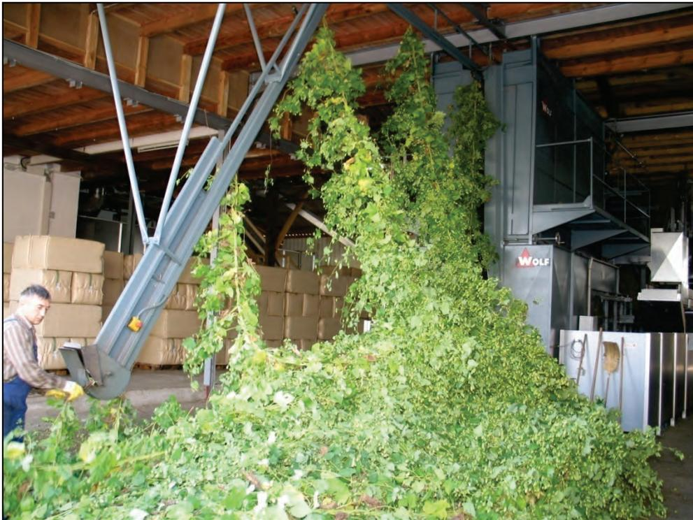
*Abb. 28: Stationäre Pflückmaschine im Einsatz*
