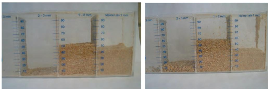
Ermittlung der Schrotfeinheit mittels Siebkasten: Weniger Partikel <1 mm bei neuen Hämmern (rechts)
