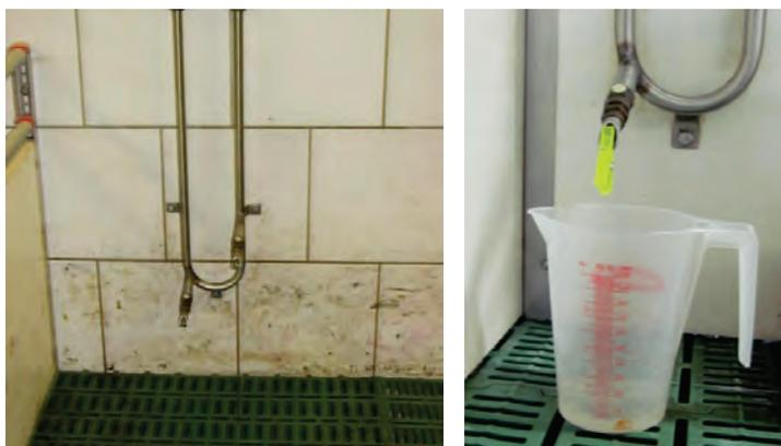
Überprüfung des Wassernachlaufes im „Normalbetrieb“ – „Öffnen“ der Nippel mit Wäscheklammern
