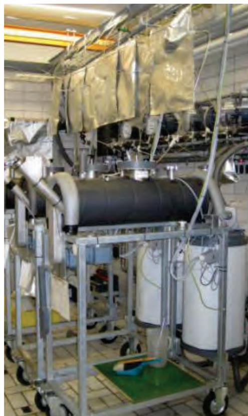
Abbildung 2: Anlagen-Beispiel für zweistufig betriebene Fermenter
