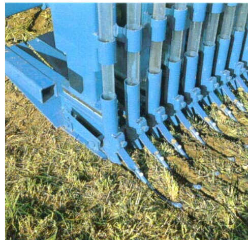
Abb. 4: Die Ablage in flachen Schlitzen ermöglicht guten Bodenschluss
