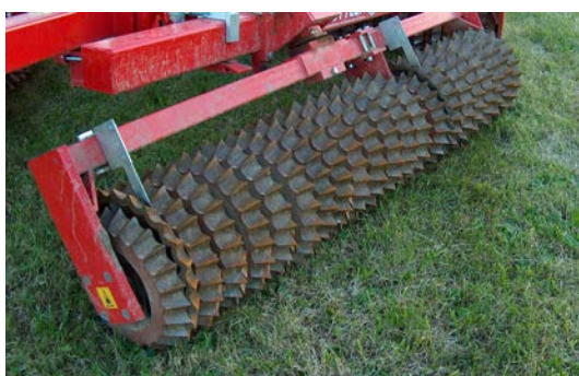
Abb. 2: Profilwalzen eignen sich besonders gut für das Anwalzen des Saatgutes
