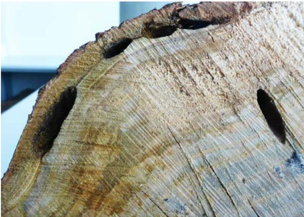
Abb. 5: Bohrgänge im Holz
