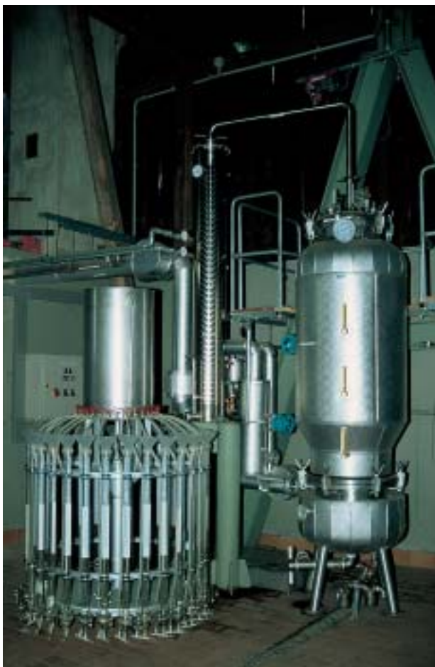
Optimierte Versuchs-Destillationsanlage mit karussellförmiger Kondensaterfassung
