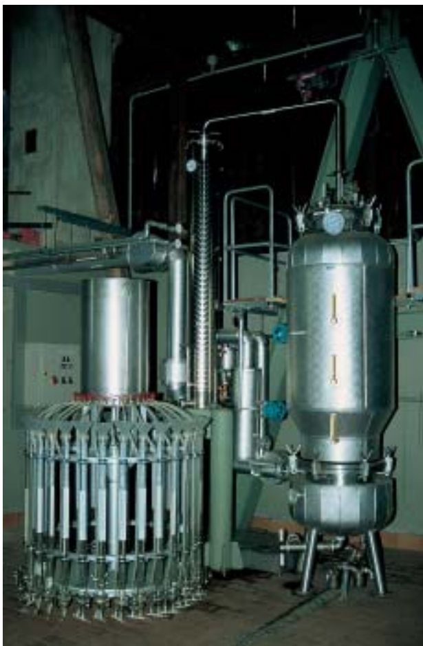
Optimierte Versuchs-Destillationsanlage mit karussellförmiger Kondensaterfassung
