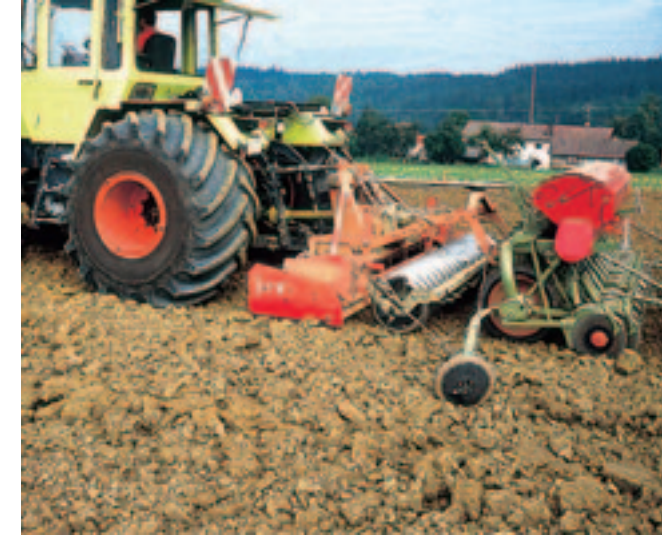
Gerätekombinationen und eine bodenschonende Bereifung schaffen bei der Zwischenfruchtsaat das ideale Saatbett.
