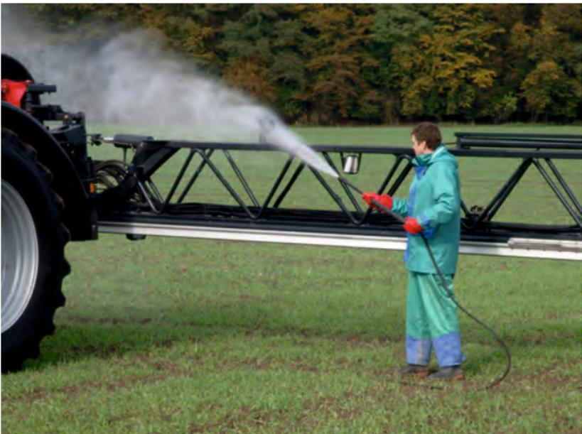
Für eine gute Reinigungsleistung ist ausreichend Wasser in Verbindung mit hohem Druck notwendig
