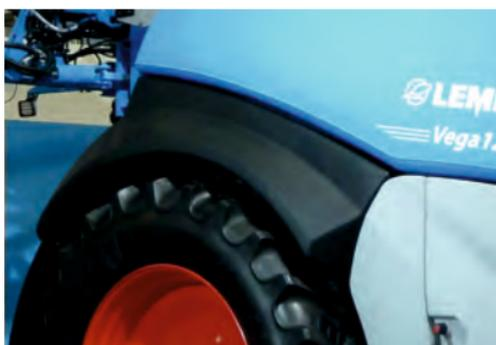
Im Kotflügel integrierter Klarwassertank
