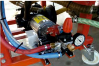
Für kleinere Geräte sind preisgünstige Elektropumpen mit Leistungen bis 30 l/min ausreichend
