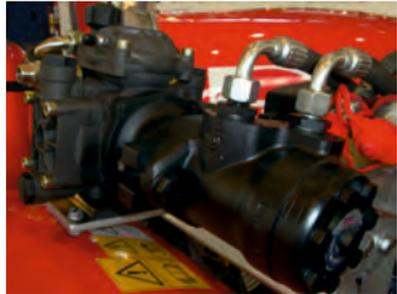
Hydraulisch angetriebene Pumpen erreichen eine hohe Förderleistung und können auch für die Außenreinigung verwendet werden
