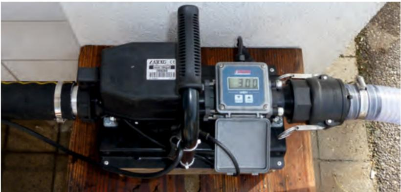
Automatische Befüllsysteme füllen definierte Mengen ein
