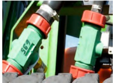
Bei indirekten mechanischen Füllstandsanzeigen (mit Schwimmern) muss die Spritze auf einer ebenen Fläche stehen, damit die genaue Füllmenge korrekt angezeigt wird. Auf dem Behälter angebrachte Skalierungen müssen gut erkennbar sein.
