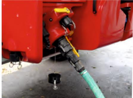
Ein Befüllanschluss mit Rückschlagventil verhindert ein Zurücklaufen der Spritzbrühe
