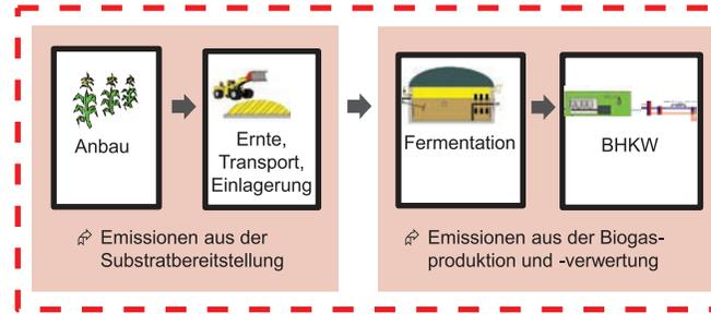
Der Material- und Energieeinsatz, welcher für die Bereitstellung der Substrate und den Anlagenbetrieb nötig ist, verursacht Emissionen bei der Herstellung und Energieumwandlung. Daneben entstehen Methan und Lachgas, die ein hohes Treibhausgaspotenzial haben.
