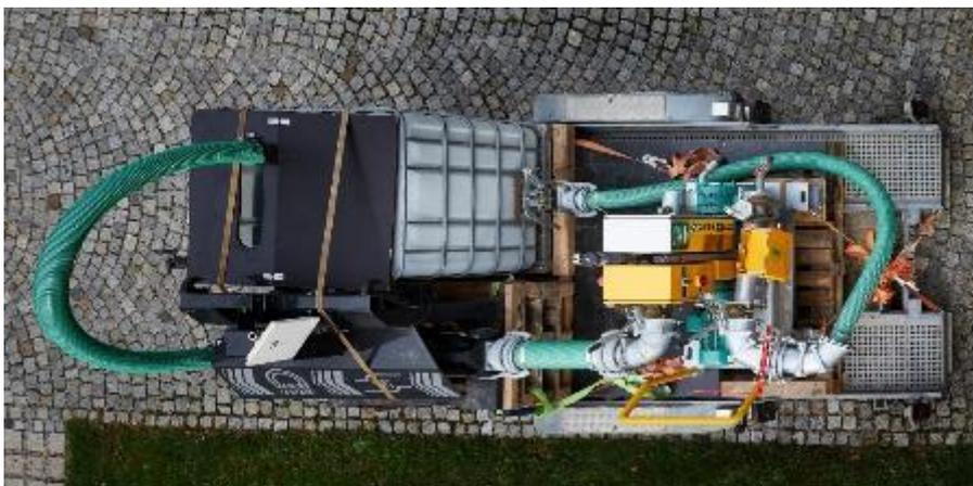
Abbildung 7: Autoanhänger mit in Reihe geschalteten NIRS Messstationen und IBC-Container.
