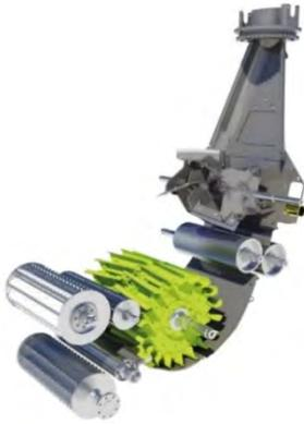
Abb. 3: Aufbau des Gutflusses im Feldhäcksler: Vorpresswalzen, Messertrommel, Corn Cracker, Auswurfbeschleuniger
