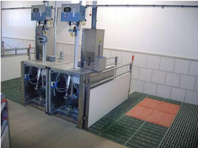
Abb. 5: Abrufstation im Ferkelabteil F2
