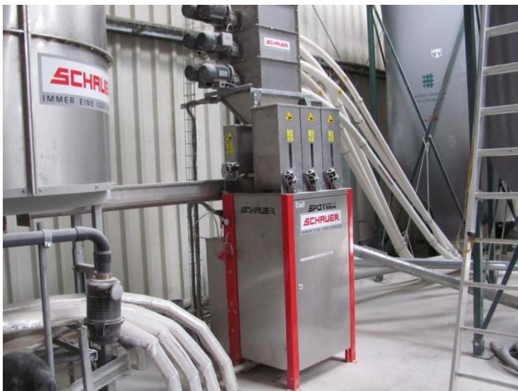
Abb. 19: Spot-Mix-Anlage zur Versorgung der Sauen und Ferkel der Lehrwerkstätte
