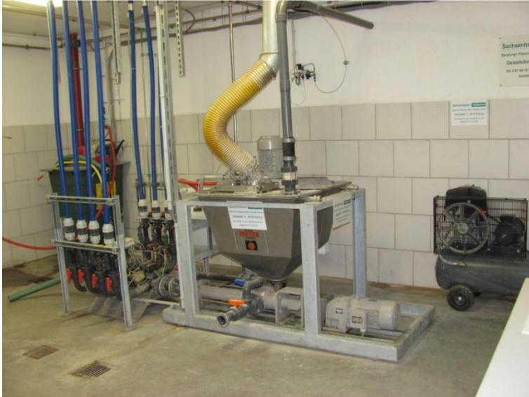
Abb. 20: Flüssigfütterungsanlage mit Stichleitungen zur Versorgung der Mastschweine der Lehrwerkstätte
