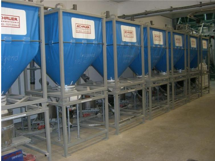
Abb. 14: „Flex-Container“ ermöglichen eine nahezu verschleppungsfreie Futterzuteilung
