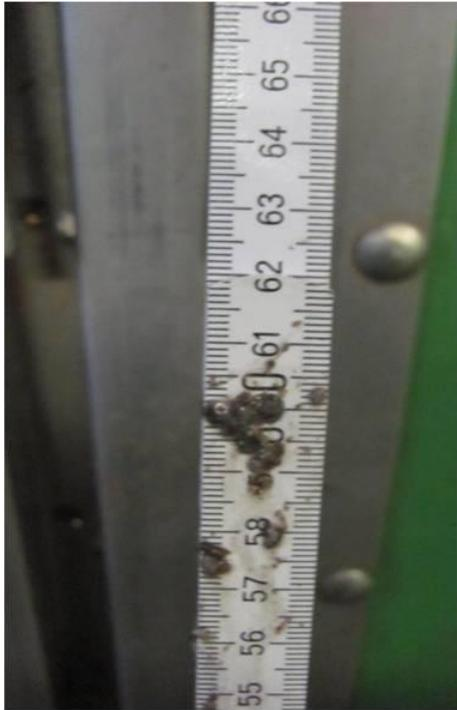
Abb. 44: Meterstab zum Ablesen des Güllepegels
