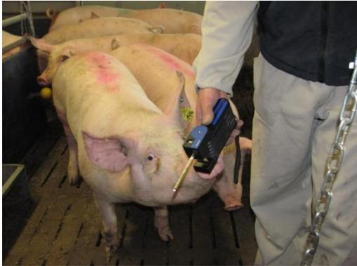
Abb. 52: Manuelle Schadgasmessung im Tierbereich
