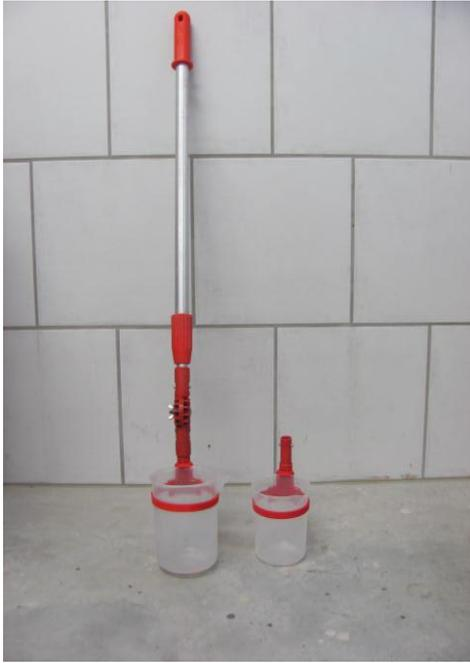
Abb. 49: Probenahmegerät für Flüssigfutter und Gülle
