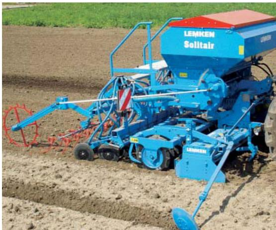
Abb. 7: Kreiselegge mit aufgebauter Scheibenschardrille
