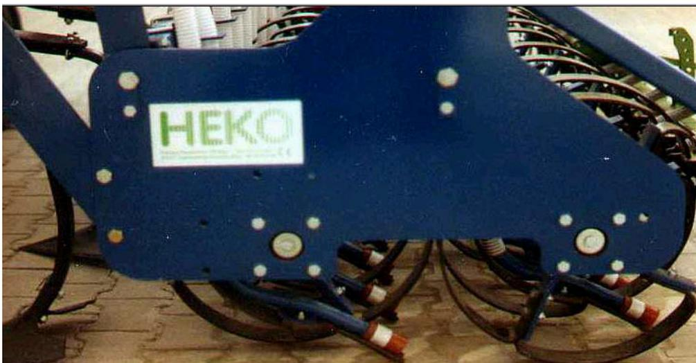
Abb. 13: Sonderform: Stempelpackerwalze mit druckbeaufschlagten Särohren
