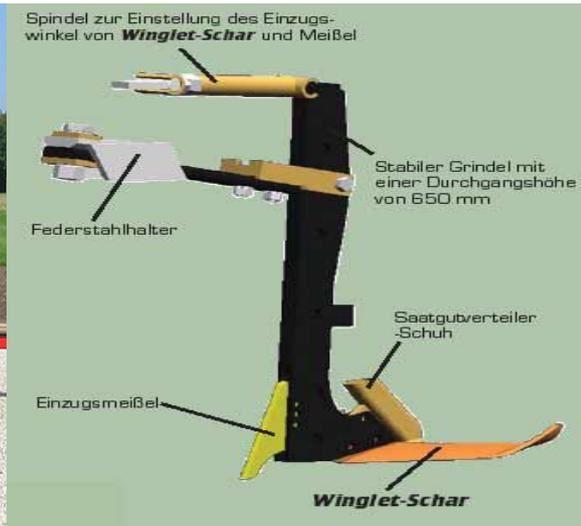
Abb.: 12 Aufbau des Winglet-Schares
