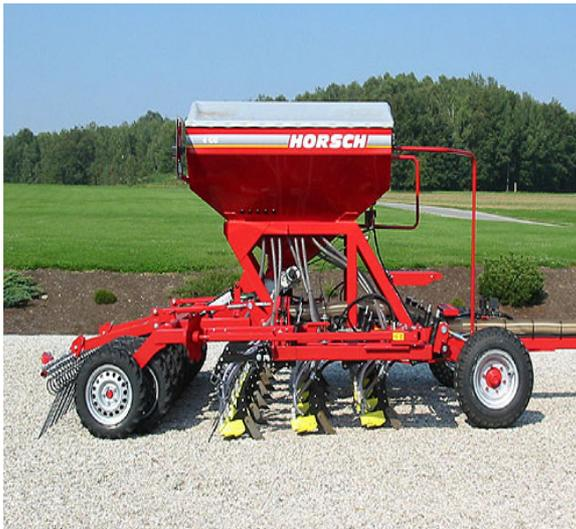
Abb.: 11 Sägrubber (Airseeder) mit Saatgutablage hinter Grubberstil
