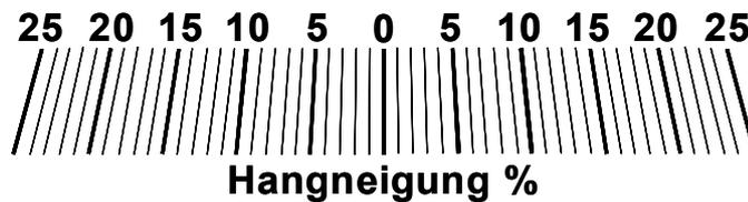
Vorlage oberhalb der Visierkante, entlang der seitlichen Skalen und unten ausschneiden und auf einen starken Karton oder eine dünne Sperrholzplatte kleben oder heften. Wichtig ist, dass die Visierkante gut mit einer Seite der Platte übereinstimmt.
