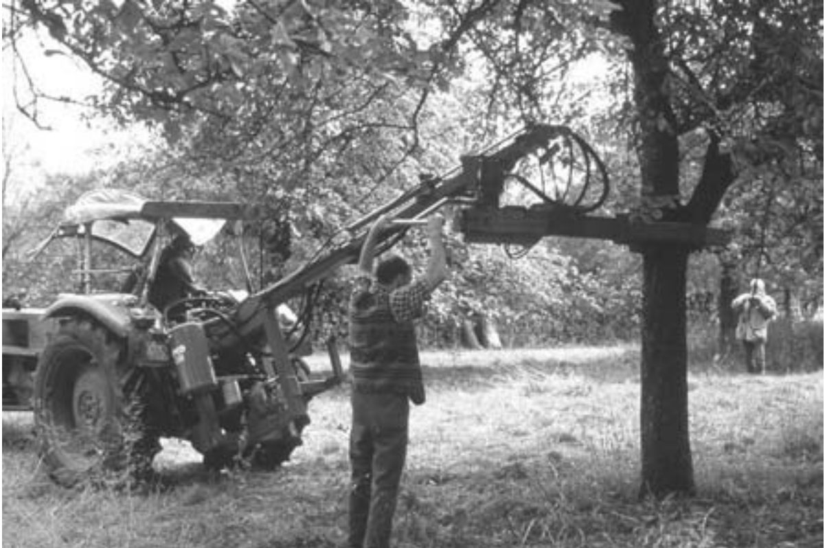
Bild 2: Der Hydraulikschüttler HSA 10 von LIPCO wird am Stamm eines Apfelbaumes festgemacht
