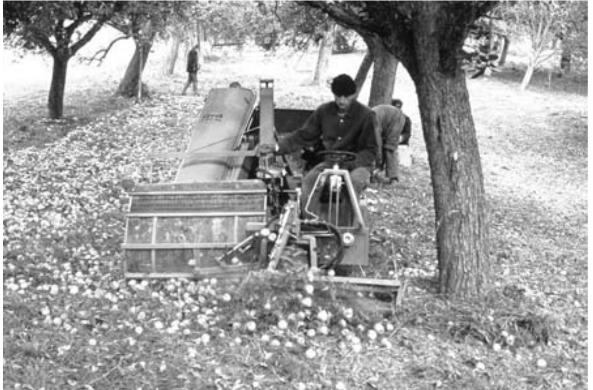
Bild 5: Die Obstauflesemaschine OB 80 von Feucht; hier werden die Körbe nach hinten weggenommen
