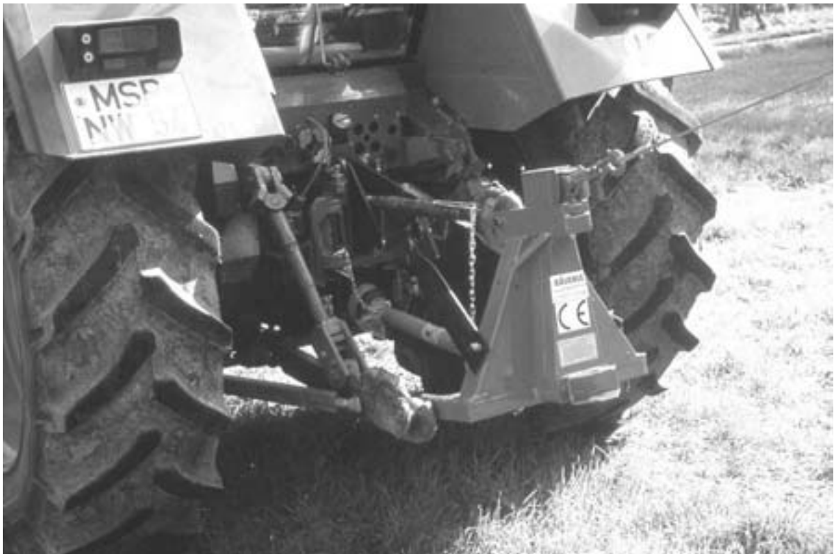
Bild 1: Der Seilschüttler von Harter, am Heck des Schleppers angebaut
