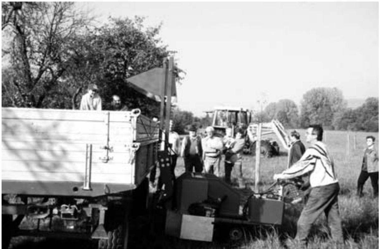
Bild 8: Ist der Bunker voll, kann er maschinell auf den Hänger entleert werden
