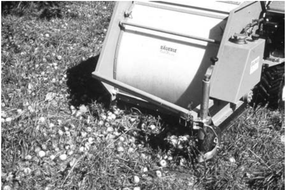
Bild 4: Das Obstwiesel OW 85 H von Bäuerle im Einsatz; die vollen Körbe werden seitlich weggenommen
