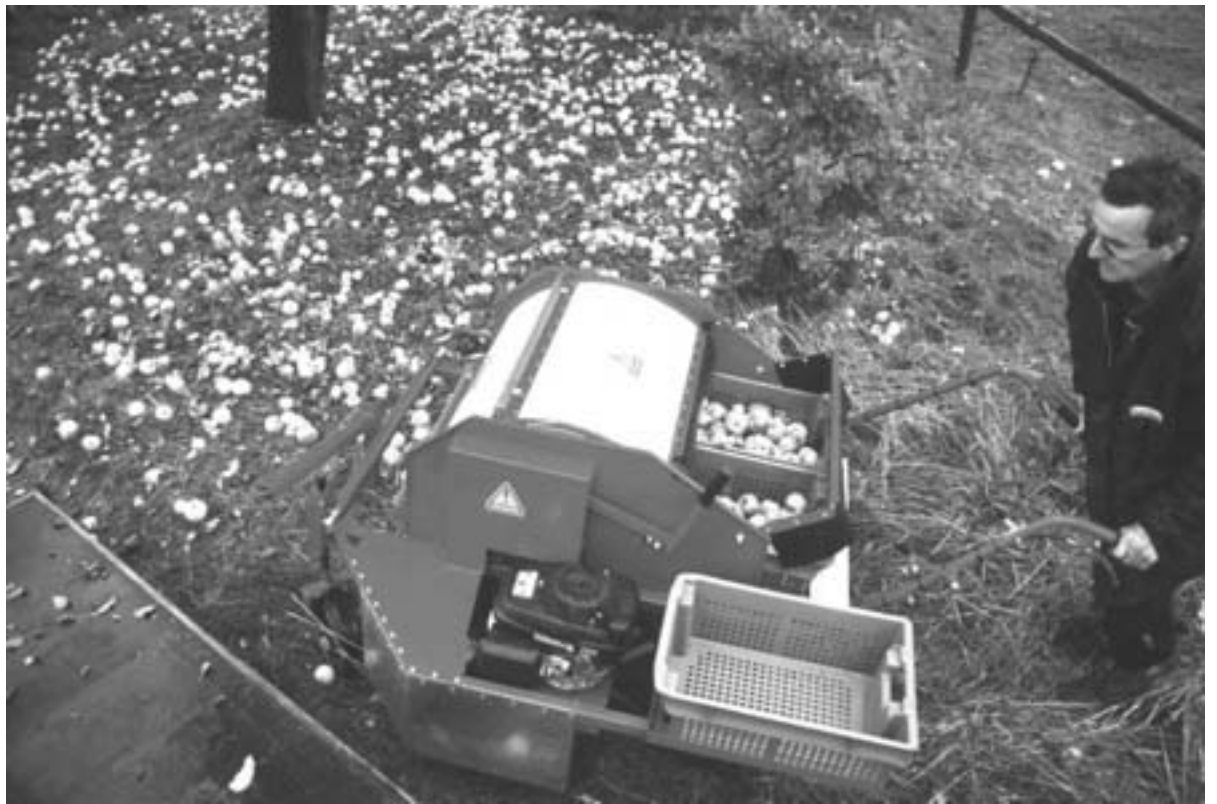
Bild 7: Die selbstfahrende Obstaflesemaschine SF 1000 von Krauß
