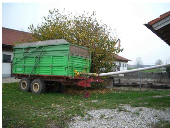
Abb. 4 + 5: Nutzung der Abwärme für die Wagentrocknung von Hackschnitzeln. Im Sommer wird die überschüssige Abwärme zur Hackschnitzeltrocknung genutzt.
