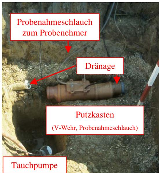
Abb. 4: Abflussmessung und Probenahme am Drän
