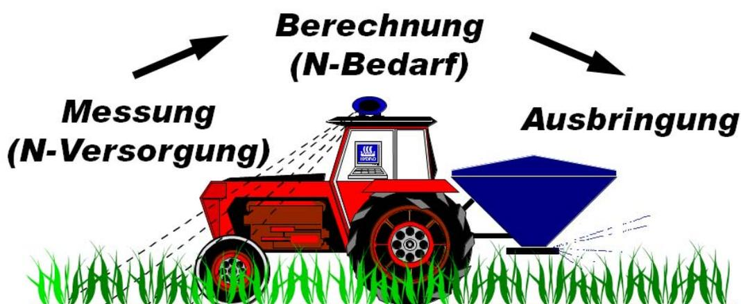
Abb. 1: YARA N-Sensor®, 3 Schritte in einem Arbeitsgang
