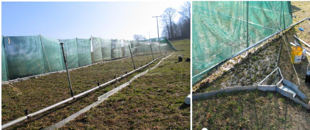
Abb. 7: Beregnungsanlage mit Windschutz und Leitblechen (links); Detailaufnahme vom trichterförmigen Abflusssammelbereich (rechts)
