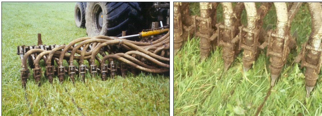
Abb. 3: Gülleausbringung mit flacher Injektion (Schlitztechnik)
