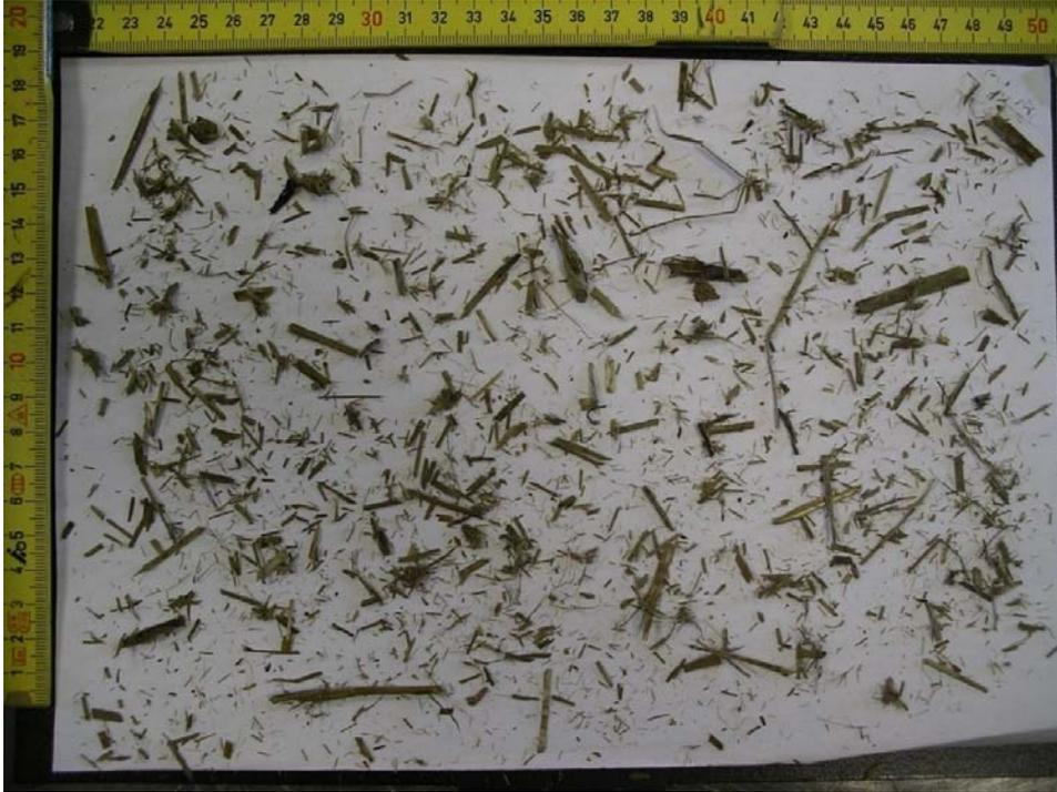
Abb. 5: Foto zur Vermessung von Partikellängen durch Bildanalyse
