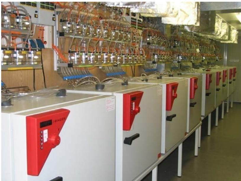
Abb. 7: Versuchsaufbau zur Ermittlung des Restgaspotentials
