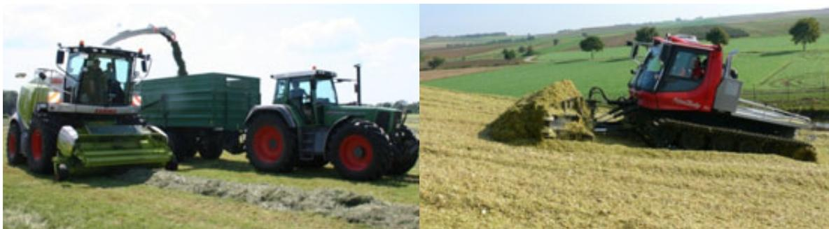
Abb. 2: Links: Feldhäcksler beim Häckseln von Gras-Anwelkgut mit Online-Ertrags- und Feuchtemesssystem
