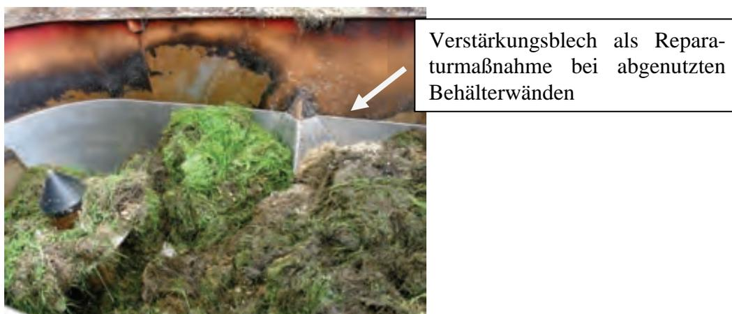
Abb. 35: Verstärkungsblech an einem Futtermischwagen-Vorlagebehälter
