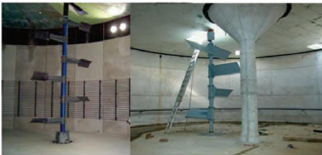
Abb. 37: Vertikale Paddelrührwerke; Quelle: Agrafarm Technologies AG
