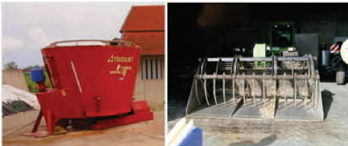
Abb. 31: links: Vorlagebehälter auf Basis der Futtermischwagentechnik, ca. 10 m<sup>3</sup> Fassungsvermögen mit vertikaler Schnecke; rechts: Greifschaufel zur Siloentnahme und Befüllung
