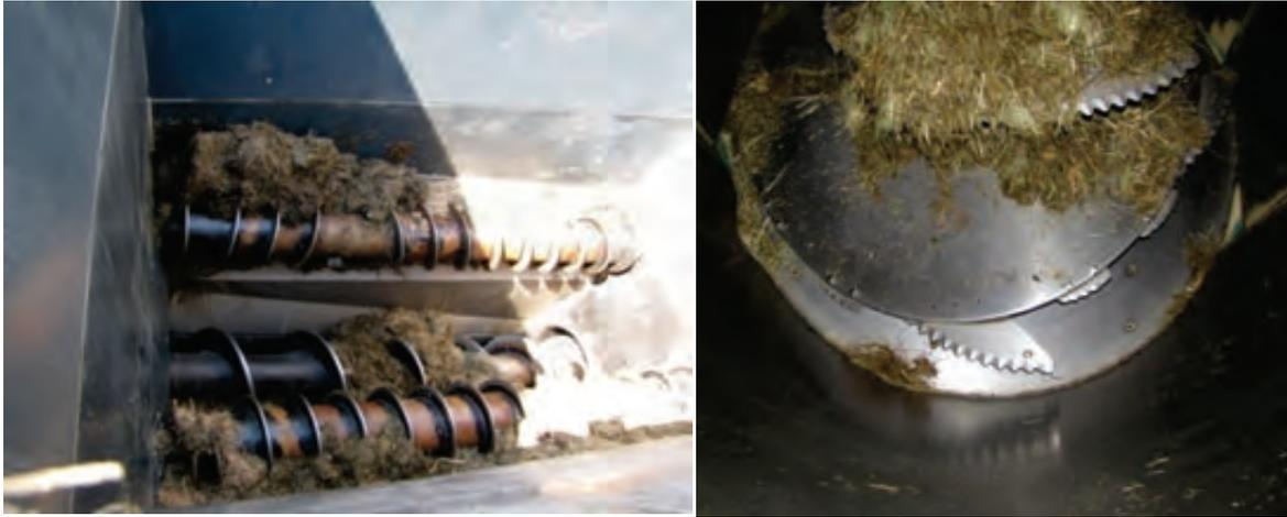
Abb. 33: links: Auflöseschnecken in einer robusten Einbringung, rechts: Mischaggregat mit Schneiden in einem Futtermischer
