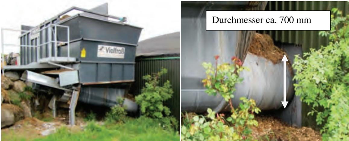
Abb. 34 Einbringschnecke seitlich in den Fermenter mit großem Durchmesser
