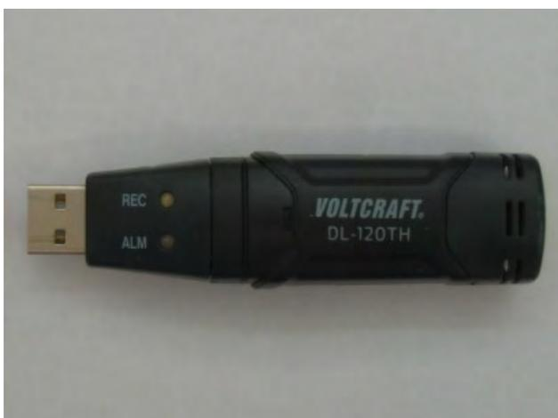
Abb. 29: USB-Datalogger zur Aufzeichnung von Lufttemperatur und relativer Luftfeuchtigkeit
