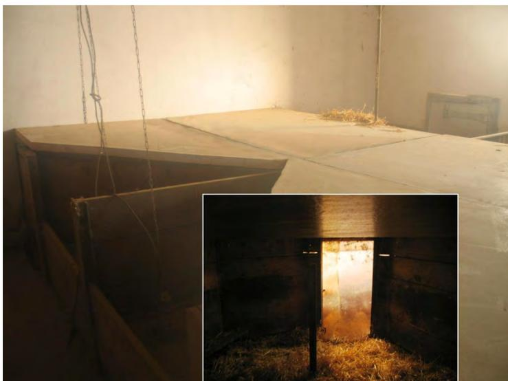
Abb. 10: Abgedeckte Liegebereiche und Durchgang zum Mistgang mit PVC-Streifen
