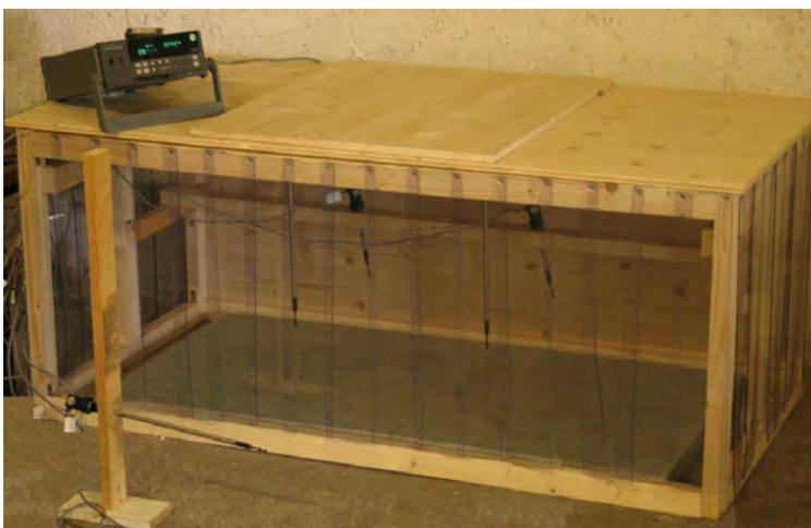
Abb. 2: Kontrollnest mit Messfühlern und Datalogger
