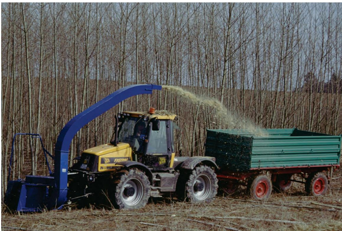
Abb. 3: Der Gehölmähhäcksler, System Wieneke/Döhner, wurde speziell für die Ernte von Kurzumtriebsplantagen entwickelt
