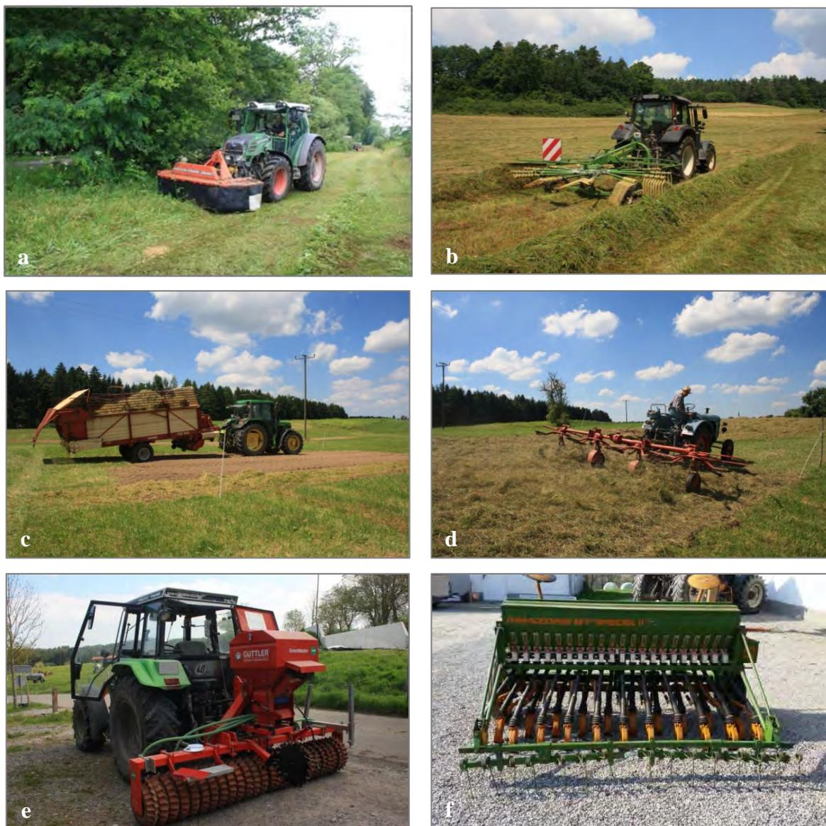
Abb. 41: Geräte für die Mahdgutübertragung und Ansaat: a) Mähwerk, b) Schwader, c) Ladewagen, d) Heuwender/Kreiselschlepper, e) Nachsaatgerät, f) herkömmliche Drillmaschine.
