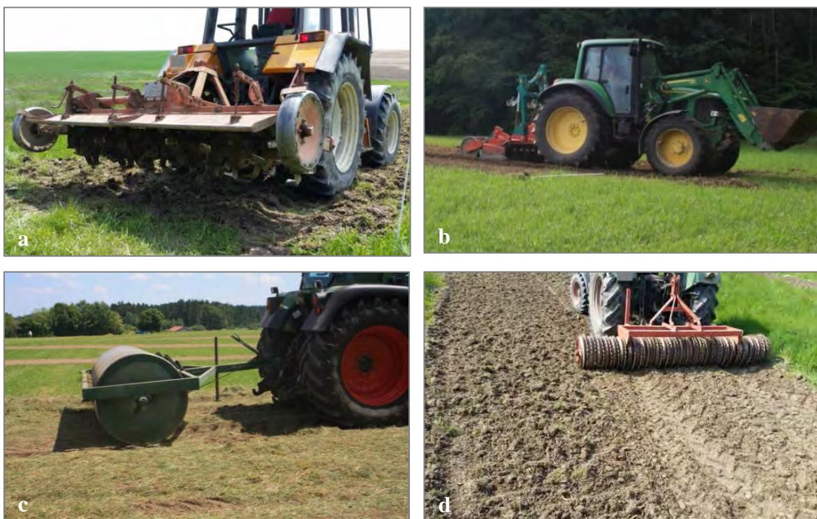
Abb. 40: Geräte für die Bodenbearbeitung der Saatstreifen: a) Bodenfräse, b) Kreiselegge, c) Wiesenwalze, d) Cambridgewalze z.B. zum Anwalzen des Saatgutes
