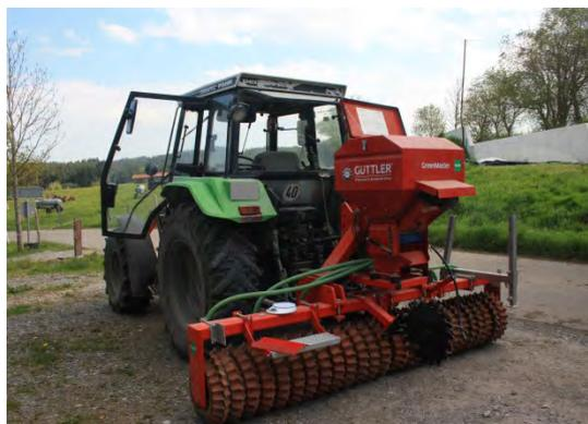
Abb. 36: Praxisaugliche Maschinen zur Ansaat: Drillmaschine kombiniert mit Kreiselegge (links) oder Prismenwalze mit Pneumatikstreuer (rechts)
