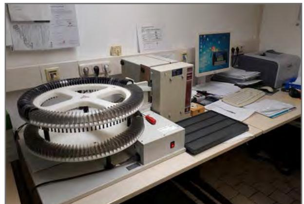
NIRSystems 6500 (Foss) Analysensystem mit Probengeber für 100 Messzellen (BJ 1996)
