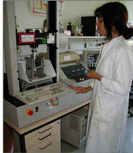
*Sabine Oppelt bei der Messung der Zartheit von Rindfleisch am Scherkraft-Messsystem*
