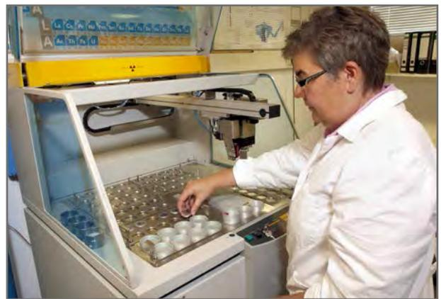
*Roswitha Harings bestimmt ausgewählte Mineralstoffe und Spurenelemente mittels Röntgenfluoreszenzanalytik*
