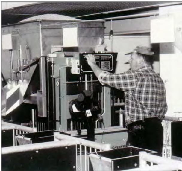
*Batteriebetriebener Gabelgehubwagen mit Waage und Scanner für Tierplatzidentifikation (1992 bis 2009)*
