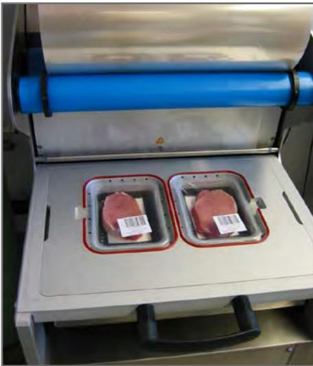
*Bestimmung des Tropfsaftverlustes unter Schutzgasatmosphäre im Standsiegelgerät*
