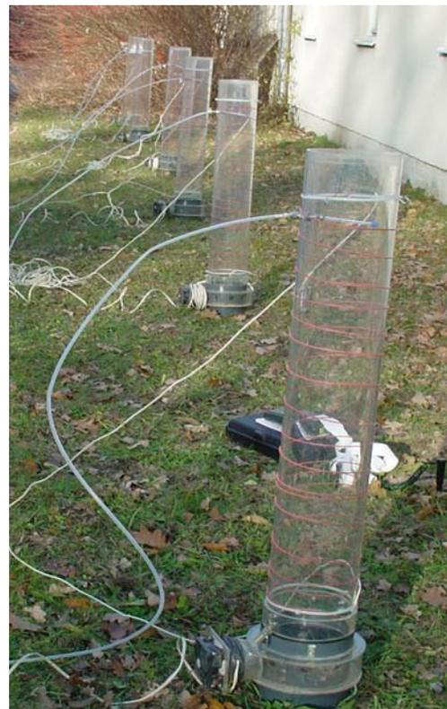
Abbildung: Küvettenversuch zur  $NH_3$ -Emission
