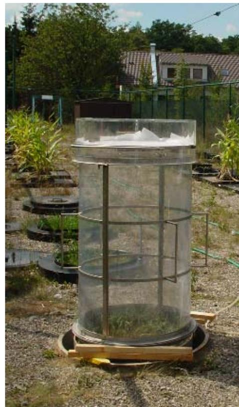
Abbildung: Berechnungskammer für Lysimeter
