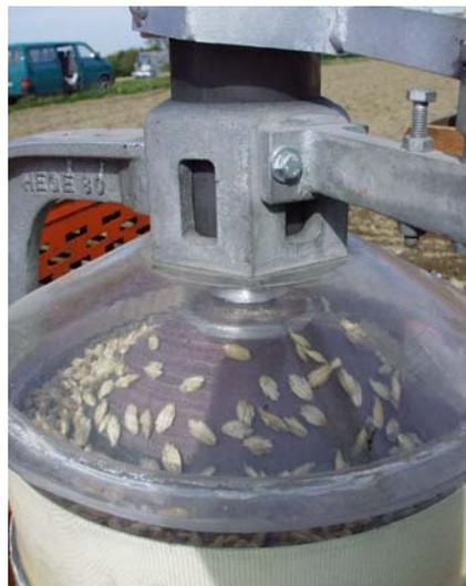
Abb. 4: Bandverteiler bei der Dinkelsaat
