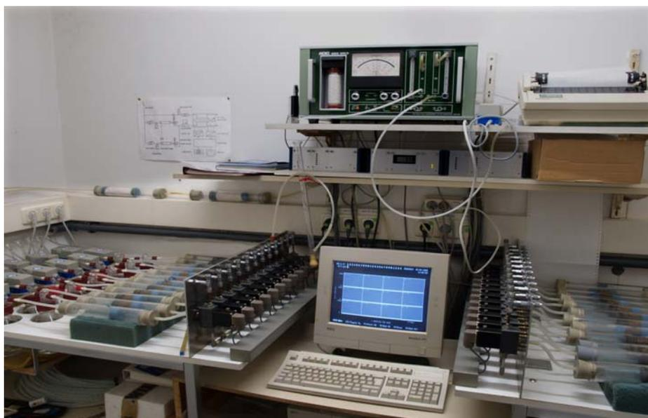
*Abb: 13: Substratinduzierte Respirationsanlage (SIR) für mikrobiologische Aktivitätsmessungen*
