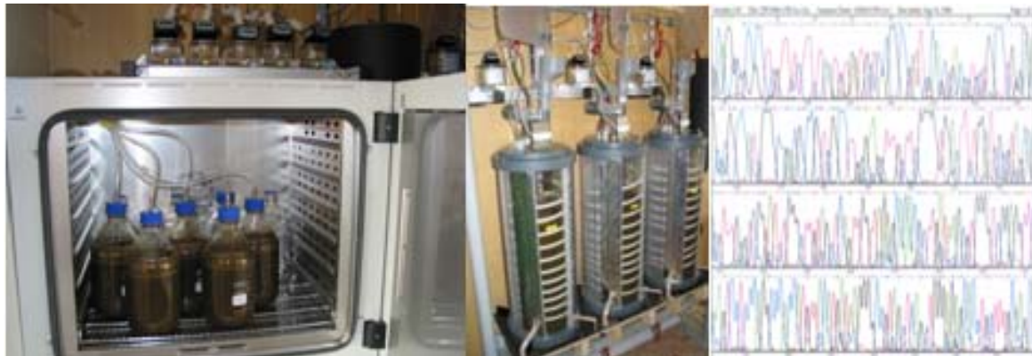
2-L-Batchversuche (links), 32-L-Durchflussversuche (mittig), mcrA-Sequenzierung (rechts)
