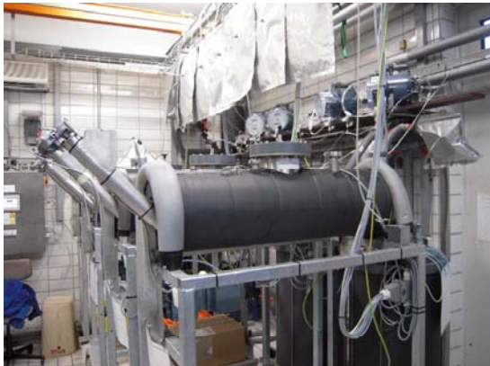
Liegender und stehender Fermenter mit Gasanalyse
