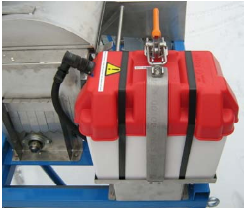
Batteriewechselsystem für verlängerte tägliche Einsatzdauer (links); Trägerfahrzeug mit automatisch verstellbarer Spurbreite zur Aufnahme von Laser-Sensoren (rechts)
