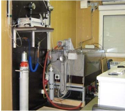
Wasserbad-Inkubation, Begasung und Mikro-Gaschromatograph im ATS-Messcontainer
