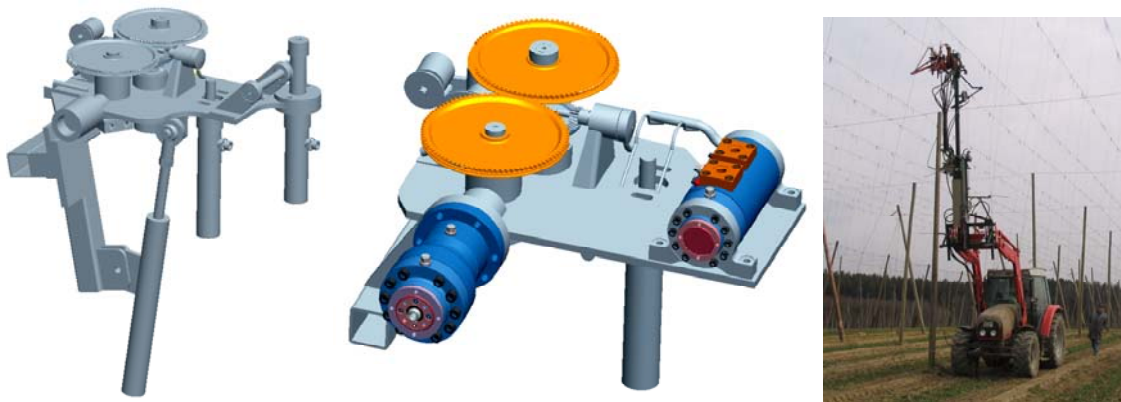
Virtueller Prototyp des Subsystems „Kopf“ (links); Optimierter virtueller Prototyp (mittig); Prototyp beim Aufhängen von Anleitdrähten in einem Hopfengarten (rechts)
