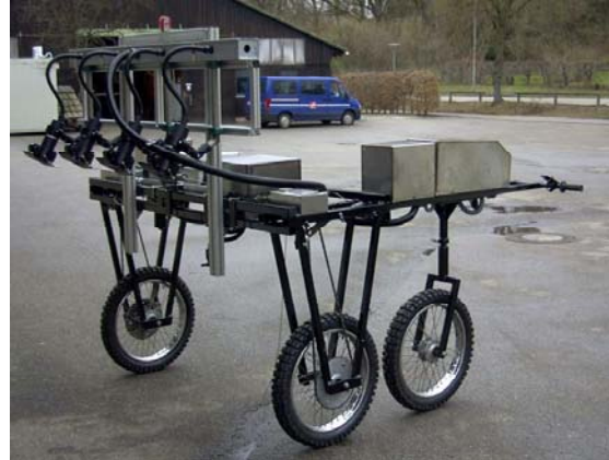
Batteriewechselsystem für verlängerte tägliche Einsatzdauer (links); Trägerfahrzeug mit automatisch verstellbarer Spurbreite zur Aufnahme von Laser-Sensoren (rechts)
