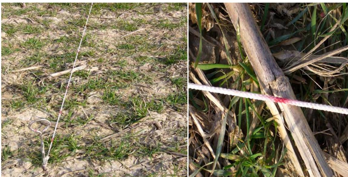
*Ermittlung der Maisstrohaufgabe mittels Zählmethode. Dazu wird eine 10 m lange Leine mit Markierung im Abstand von 20 cm ausgelegt und die Markierungen gewertet, unter denen punktgenau Maisstroh liegt. Ein Markierungspunkt über Maisstängel entspricht 2 % Deckung.*
