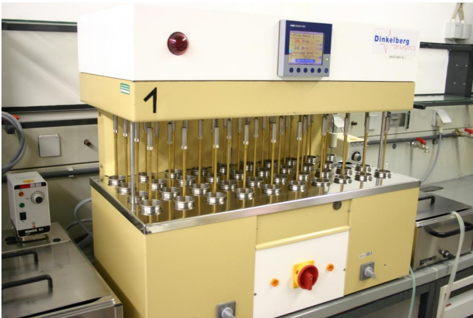
Abbildung: Die neu umgebauten Maischbäder des Jahres 2007. Eine vollkommen neue Steuerelektronik und die Überwachung des Maischprozesses verbessert die Qualität der Brauwertuntersuchungen
