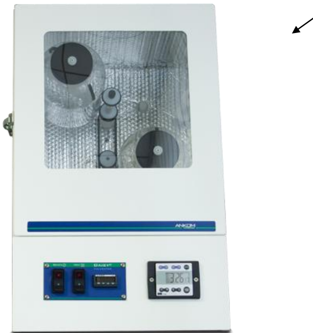
Abb. 5 In-vitro Inkubator mit eingesetzten Flaschen in denen die Enzymbehandlung abläuft
